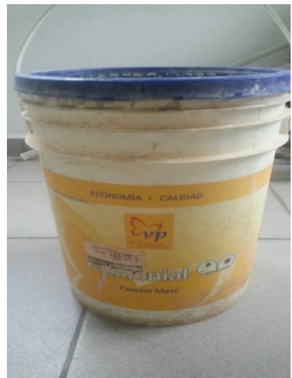
Figura 8. Tobo para medir caudal, de 18 litros
