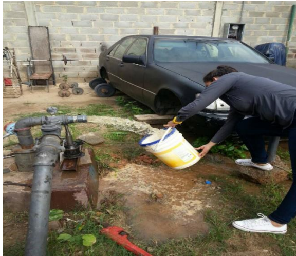
Figura 22. Medición de caudal del pozo Los Colores Coordenadas UTM 613503E; 1134139N. Elevación: 469 msnm. Zona norte, Municipio San Diego, Estado Carabobo. Fecha: 03/04/2017
