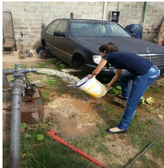
Figura 23. Medición de caudal del pozo Los Colores Coordenadas UTM 613503E; 1134139N. Elevación: 469 msnm. Zona norte, Municipio San Diego, Estado Carabobo. Fecha: 23/03/2017
