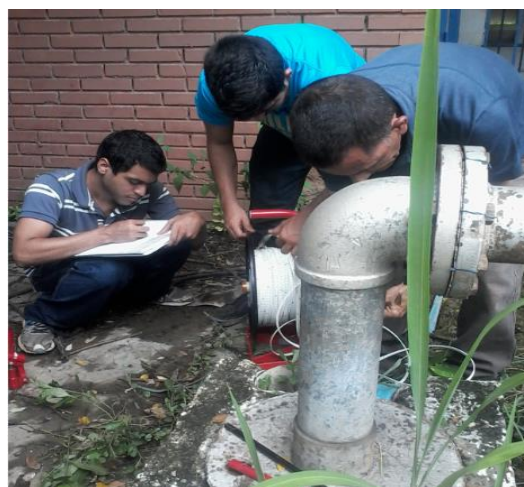
Figura 17. Medición de nivel dinámico del pozo Fin de Siglo en compañía del Licdo. Juan De Farías Coordenadas UTM 613362E; 1130425N. Elevación: 465 msnm. Zona centro, Municipio San Diego, Estado Carabobo. Fecha: 04/08/2017
