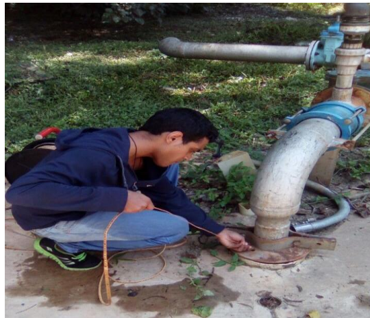
Figura 25. Medición del nivel freático del pozo Parque Metropolitano (dinámico) Coordenadas UTM 613957E; 1130618N. Elevación: 476 msnm. Zona centro, Municipio San Diego, Edo. Carabobo. Fecha: 25/08/17.
