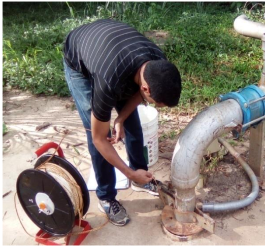
Figura 20. Lectura del nivel freático del pozo Parque Metropolitano de Coordenadas UTM 613957E; 1130618N. Elevación: 476 msnm. Zona centro, Municipio San Diego, Estado Carabobo. Fecha: 11/08/2017.
