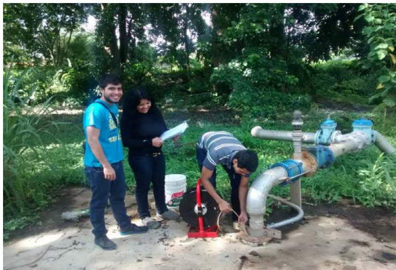
Figura 23. Medición del caudal del pozo Parque Metropolitano en compañía de la Ing. Adriana Márquez Coordenadas UTM 613957E; 1130618N. Elevación: 476 msnm. Zona centro, Municipio San Diego, Estado Carabobo. Fecha: 18/08/2017.
