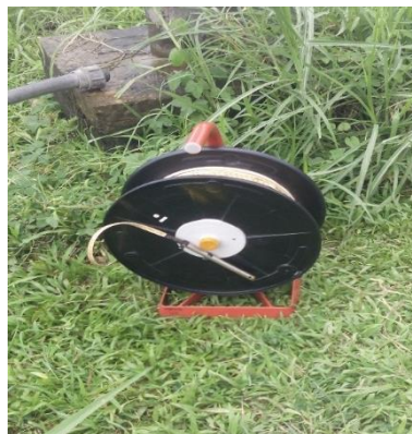
Figura 7. Sonda marca PLM utilizada para medir nivel.
