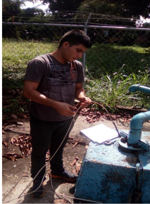
Figura 24. Medición del nivel freático del pozo Montaserino (dinámico) Coordenadas UTM 613448E; 1134925N. Elevación: 468 msnm. Zona centro, Municipio San Diego, Edo. Carabobo. Fecha: 25/08/17.
