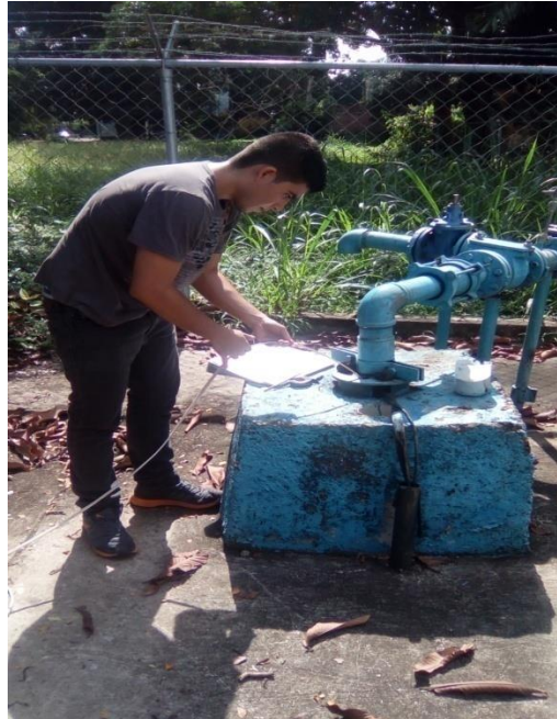
Figura 21. Lectura del nivel freático del pozo Montaserino de UTM 613448E; 1134925N. Elevación: 468 msnm. Zona centro, Municipio San Diego, Estado Carabobo. Fecha: 11/08/2017.
