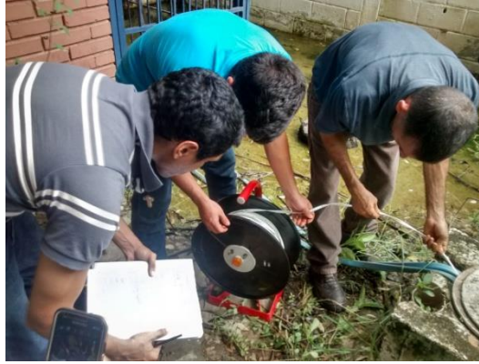
Figura 86. Lectura del nivel dinámico del pozo Fin de Siglo en compañía del Licdo. Juan De Farías Coordenadas UTM 613362E; 1130425N. Elevación: 465 msnm. Zona centro, Municipio San Diego, Estado Carabobo. Fecha: 18/08/2017.
