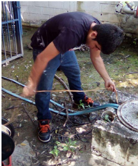
Figura 27. Lectura del nivel dinámico del pozo Fin de Siglo Coordenadas UTM 613362E; 1130425N. Elevación: 465 msnm. Zona centro, Municipio San Diego, Estado Carabobo. Fecha: 01/09/2017.
