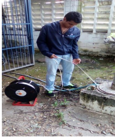
Figura 82. Lectura del nivel dinámico del pozo Fin de Siglo Coordenadas UTM 613362E; 1130425N. Elevación: 465 msnm. Zona centro, Municipio San Diego, Estado Carabobo. Fecha: 25/08/2017.
