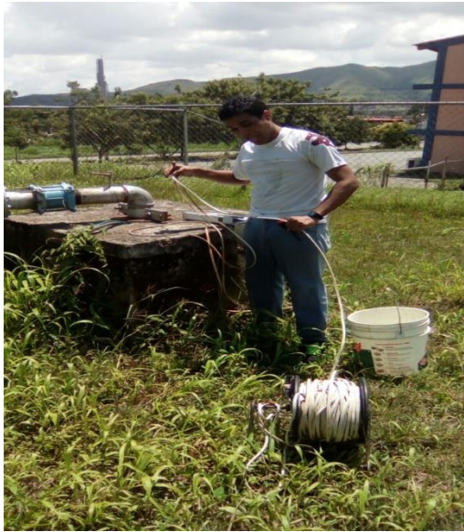
Figura 26. Medición del nivel freático del pozo Yuma (dinámico) Coordenadas UTM 614197E; 1130251N. Elevación: 463 msnm. Zona centro, Municipio San Diego, Edo. Carabobo. Fecha: 01/09/17.
