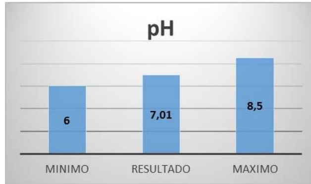
Figura 18. Comparación de los Resultados del pH Obtenido para el Pozo N°1, Coordenadas UTM 613.940,99 E; 1.135.141,28 N, elevación 475,89 m.s.n.m., Sector Norte-C, municipio San Diego, Edo. Carabobo., respecto a lo establecido en el decreto 3219. Fuente: Los Autores (2019)
