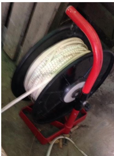
Figura 1. Sonda Marca PLM de 1000m de Profundidad, Utilizada para Realizar las Mediciones de Nivel. Fuente: Los Autores (2019)
